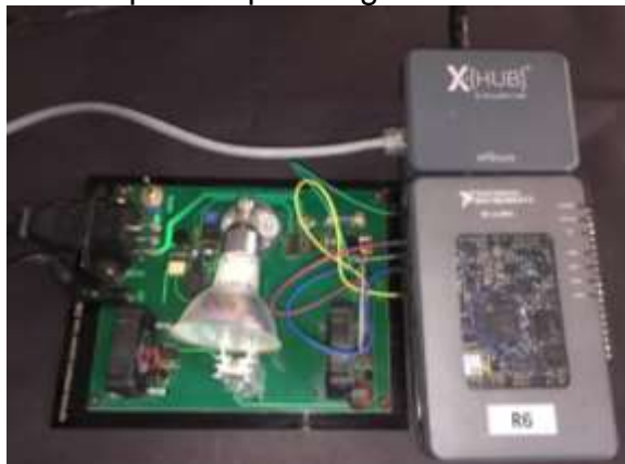
Figura 32. Fotografía de la planta de control de temperatura.
